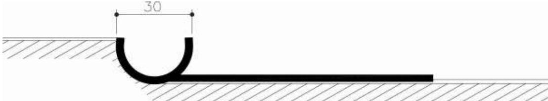
**DETALHE 3.3 - Seção longitudinal – Detalhe da drenagem secundária**
